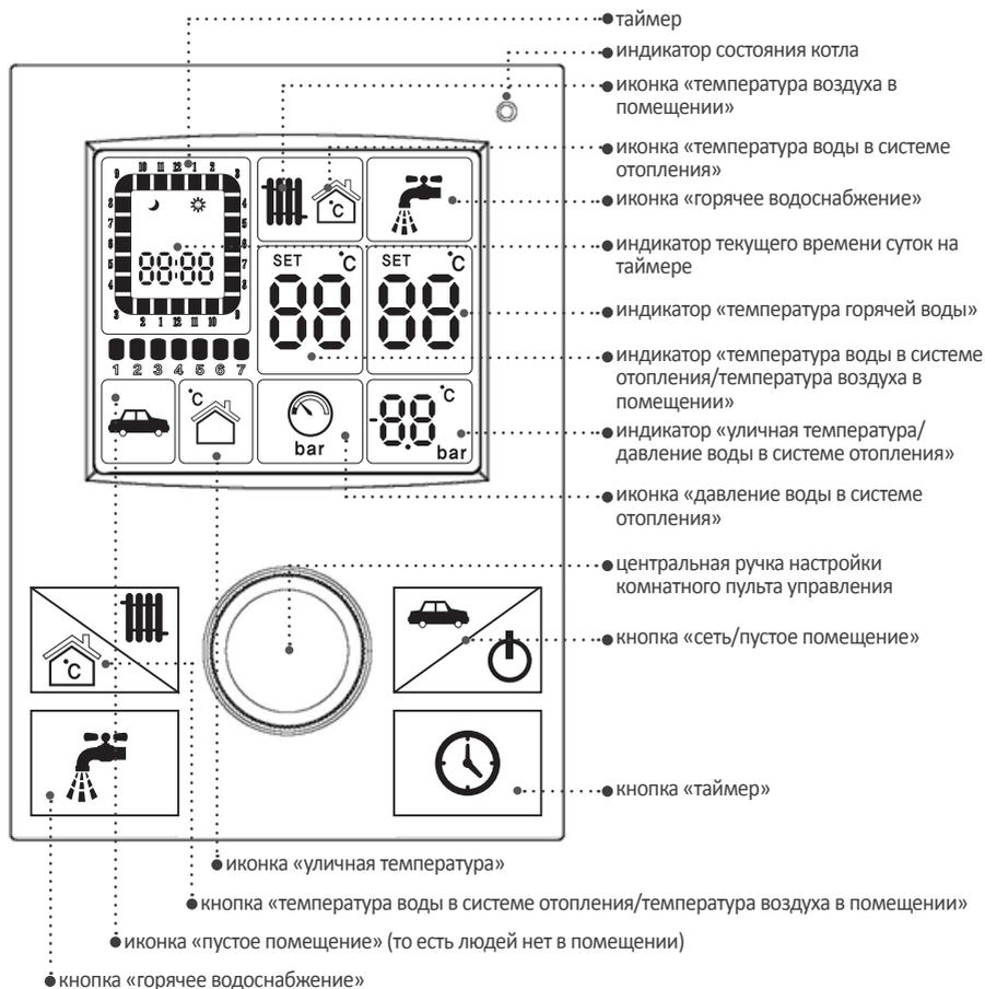
※ пульт управления газовым котлом находится на передней панели корпуса котла; как опция может быть предложен дублирующий, внешне точно такой же, выносной комнатный пульт управления
